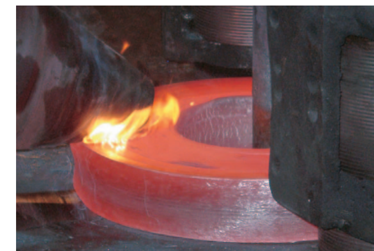
Kování průvlatku z mat. ALBROMET 380 na prstencové válcovací stoličce
